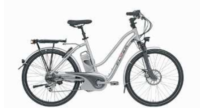
Als Kleinkraftrad mit niedriger Leistung klassifiziertes Elektrofahrrad
